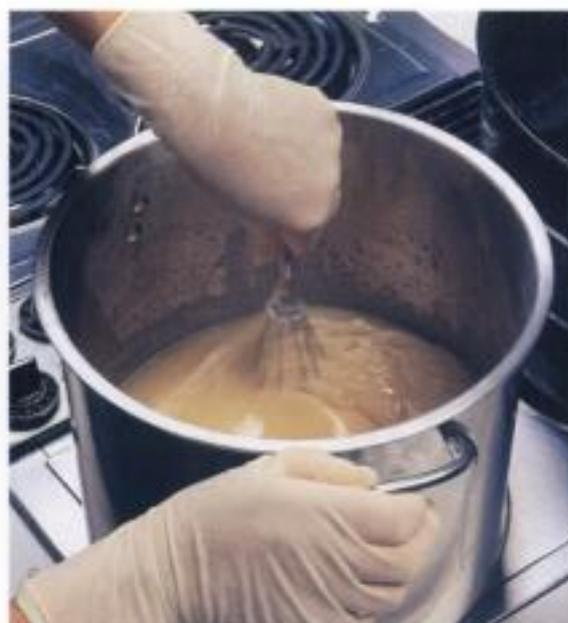
Añada el alcohol directamente a la mezcla de aceites y lejía. Al principio, la solución se separa en dos capas, podrá observar la capa aceitosa arremolinada en la superficie. Remueva durante varios minutos hasta que la solución tenga un aspecto homogéneo. Deje de remover y mire si vuelve a formarse la capa de aceite. Si reaparece, siga removiendo hasta que se disuelva por completo.
