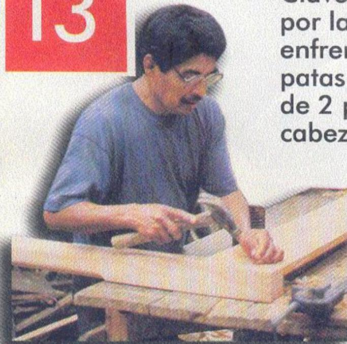
Clave las espigas por la parte de enfrente de las patas con clavos de 2 pulgadas sin cabeza. Bote los clavos y empareje con cepillo todas las uniones del armazón de la mesa.
