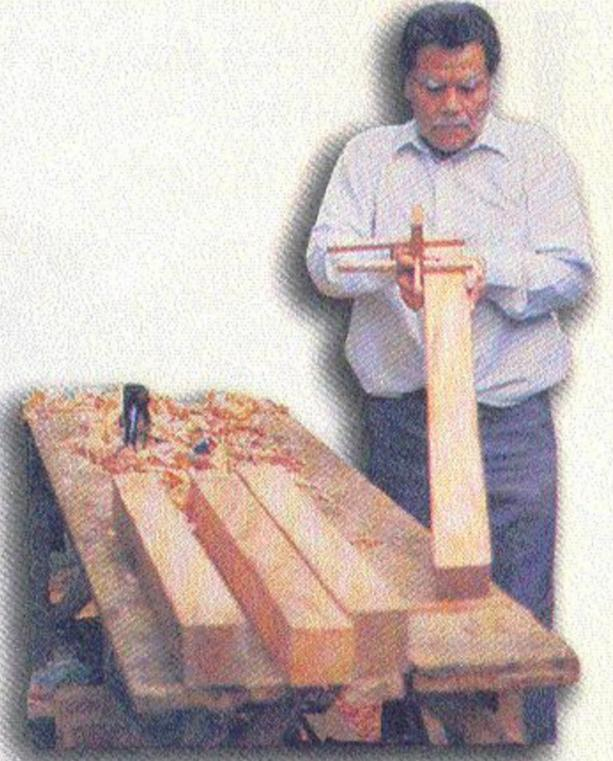
Con el gramil trace en los lados C 2 y T dos líneas paralelas, una a 22 mm y otra a 10 mm. Estas deberán tener 200 mm de longitud, desde la parte superior de la pata.
