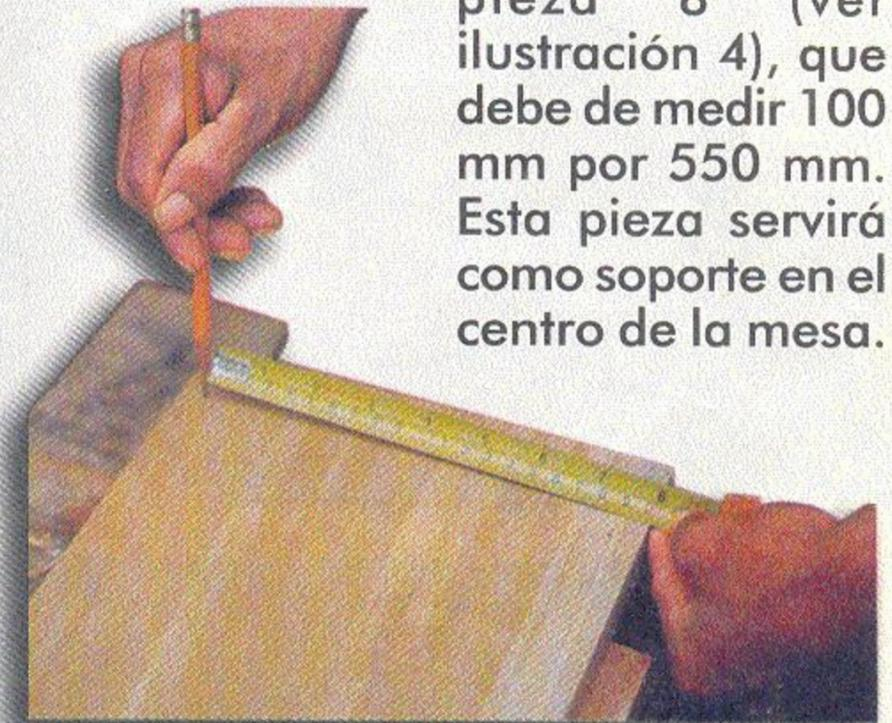
Del pedazo de tabla de 31 cm por 3 m de largo que queda, corte la pieza 8 (ver ilustración 4), que debe de medir 100 mm por 550 mm. Esta pieza servirá como soporte en el centro de la mesa.
