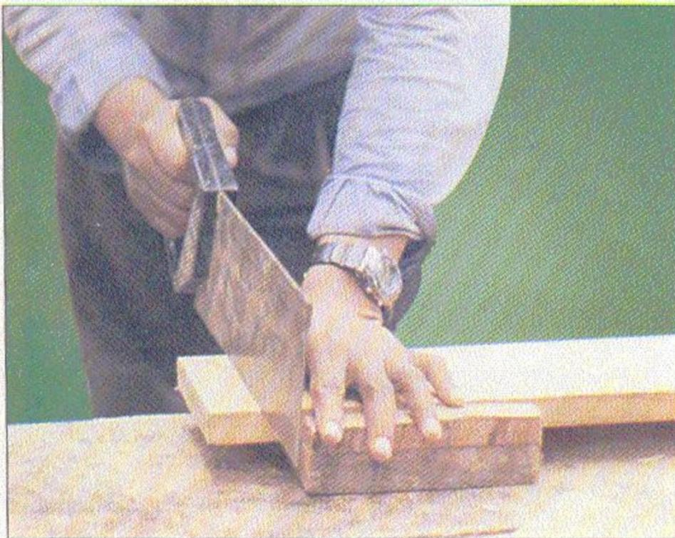
**9** Con el serrote de costilla, corte en la línea marcada a 35 mm para hacer una espiga que tenga un espesor de 13 mm.
