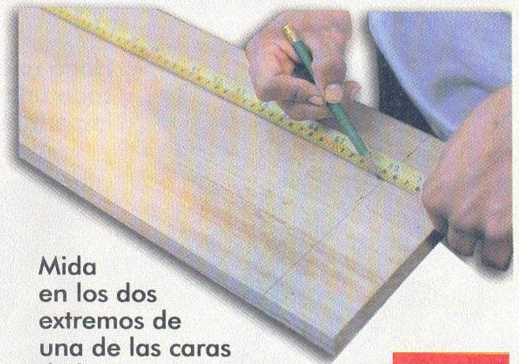
Mida en los dos extremos de una de las caras de las piezas 4, 5, 6 y 7, 50 mm hacia el centro de todas las tablas y trace una línea sobre la medición en sus dos caras y cantos.
