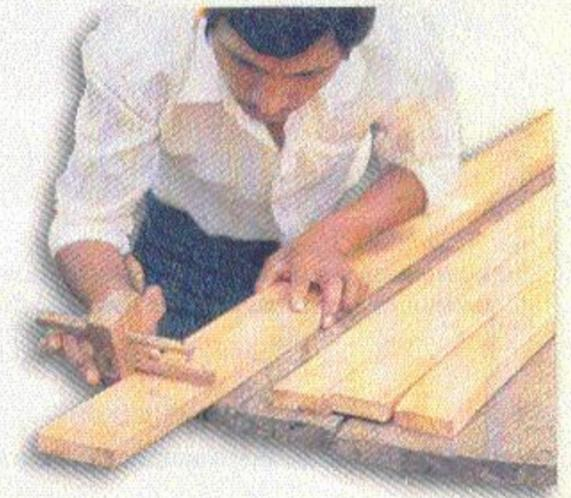
**3** Gramilar. Significa trazar una línea o marca a una distancia determinada paralela a una orilla de la madera. Lo anterior se hace con un aparato llamado gramil.
