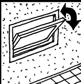
**VENTANA BALANCIN:** permite un buen control de la ventilación. Se puede mantener abierta aún estando lloviendo. Ayuda a generar una circulación de aire alta. Permite una fácil limpieza del vidrio. No es posible colocar cortina de enrollar, ni postigón de protección.
