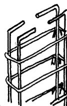
Deberemos introducir los hierros en la viga superior o carrera doblando las puntas. Ataremos entonces las 2 armaduras.
