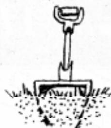
Si la pala penetra sin mucho esfuerzo el suelo es blando, tiene una resistencia baja.
