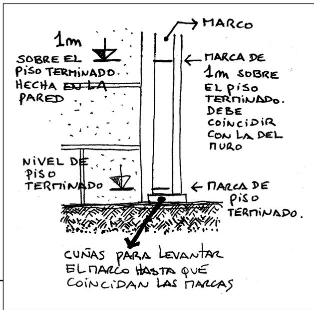
Nos queda nivelar el marco usando la plomada como indica el dibujo. En ambas direcciones, para asegurarnos que quede bien aplomado.
