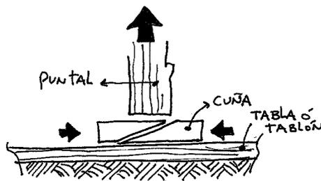
**Empujando hacia adentro las cuñas podremos levantar el encofrado. Si no existieran éstas, no podríamos desencofrar la losa.**
