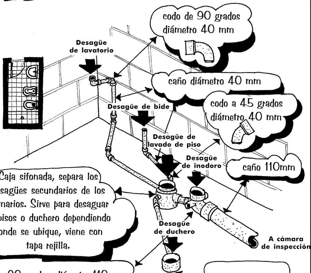
Caja sifonada, separa los desagües secundarios de los primarios. Sirve para desaguar pisos o duchero dependiendo donde se ubique, viene con tapa rejilla.
