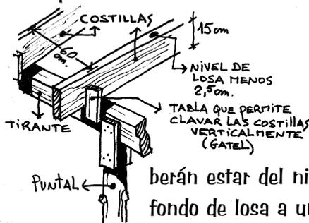
berán estar del nivel de fondo de losa a una separación igual al del espesor de la tabla que usaremos para el encofrado (normalmente 2,5 cm). Para ubicar la parte alta del tirante restaremos los 15 cm. de las tablas de costillas.
