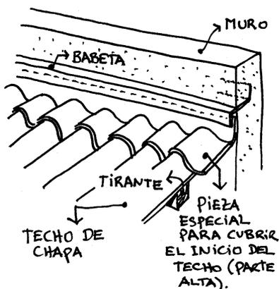
Cuando el techo comienza directamente desde un muro que sobresale, deberemos colocar una pieza especial que tiene la forma de las ondas de la chapa del techo. Esta pieza que irá sujeta al muro para su unión con éste, deberá cubrirse con una baveta de chapa galvanizada amurada con arena y cemento portland con hidrófugo.
