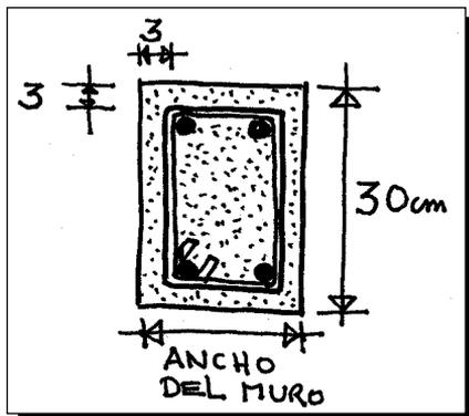
La armadura corresponderá a 4 hierros comunes de 10mm. con estribos de hierro común de 6 cada 25 cm. Como la carrera estará en contacto con la humedad de la tierra nos aseguraremos un recubrimiento de hormigón de unos 3 cm.
