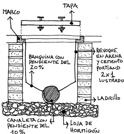
Las cámaras de inspección sirven para acceder a las cañerías. Las hay de ladrillos, hormigón y PVC.
