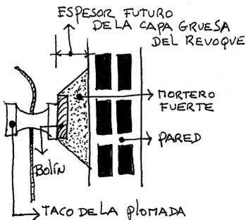
Para hacer una faja colocaremos un taquito de madera próximo al techo, éste tendrá la altura del espesor de la capa gruesa de revoque. Este espesor dependerá de que tan a plomo esté la pared; cuanto más perfecta la hayamos levantado, más fina será la capa de revoque.
