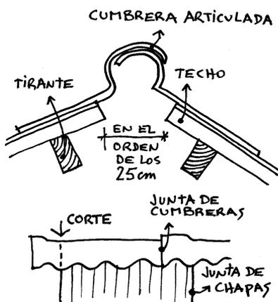
Cuando tenemos en nuestro techo una cumbrera por ser éste a 2 aguas, deberemos usar una pieza especial para cumbrera. Tendremos que cuidar que el solape de estos elementos no coincida con el de las chapas de techo. Para ello cortaremos la primera cumbrera como indica el gráfico, esto nos permitirá ir desfazados con la chapa.
