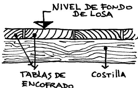
Para armar el encofrado comenzaremos por el perímetro, colocando tirantes apoyados sobre puntales a medida. Sobre éstos apoyaremos las costillas cada 60 cm, hechas de tablas separadas entre sí.
