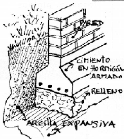
Una método que es posible utilizar para disminuir el problema del empuje hacia arriba del suelo, es rellenar con un material no expansivo como ser arena o un hormigón ciclópeo.
