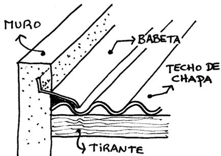
Cuando nuestro techo termine contra una pared, deberemos amurar una baveta de chapa galvanizada. Usaremos para ello arena y cemento portland con hidrófugo para evitar la entrada del agua por la unión de ésta con el muro.
