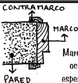
Marco tipo cajón, ocupa todo el espesor del muro.
