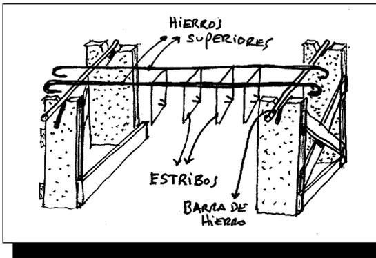
**2** Colocaremos las dos varillas correspondientes a los ángulos superiores de la viga sobre caballetes, cuyos apoyos sean una barra de hierro de unos 10-12 mm.
