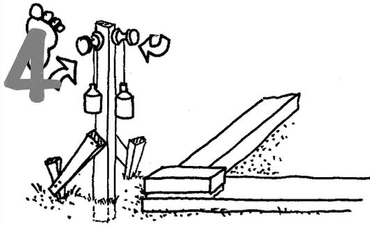
Colocaremos una regla de aluminio o madera, en cada extremo del muro, bien aplomadas en sus 2 sentidos principales. A ellas debemos colocarle un hilo que coincida con la cara exterior de la pared que queremos levantar.
