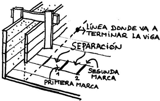
La primer marca se ubicará a la distancia de una separación con respecto al apoyo de la losa (viga o carrera). Continuaremos con ellas hasta cubrir todo el desarrollo del encofrado.
