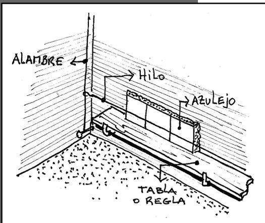
Este método permite colocar el piso por debajo del azulejo. Una vez colocado el pavimento podremos pegar la primera hilada de azulejos.
