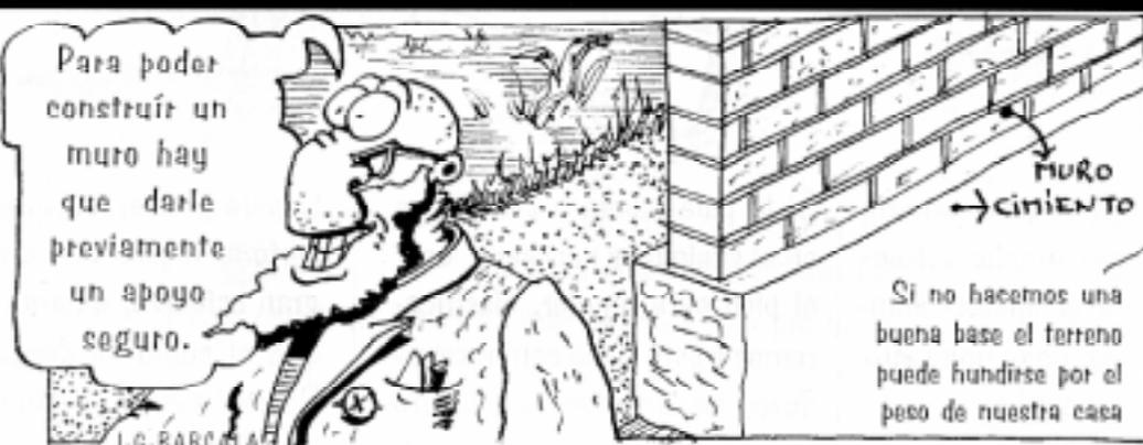
Si el suelo cede, los muros descienden y si eso ocurre pueden aparecer fisuras en las paredes y en el peor de los casos un derrumbe de la construcción.
