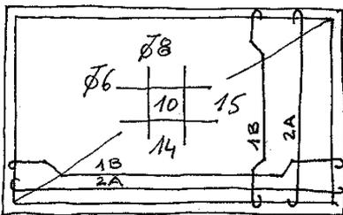
Tendremos entonces 35 varillas de 8 mm. de las cuales 12 irán levantadas en los bordes de apoyo de la losa. Tendremos 22 varillas de 6 mm. de las cuales 7 irán levantadas en sus extremos. Mediremos entonces cada tipo de varilla para saber la cantidad de hierro que debemos comprar.
