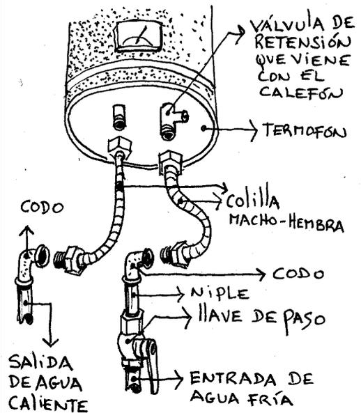
Es necesario colocar una llave de paso en la conexión del calefón con el agua fría para poder cortar el ingreso de la misma si hay problemas con éste.
