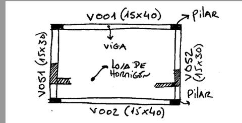
Se las dibuja de apoyo a apoyo con 2 líneas o una con flecha en ambas puntas.
