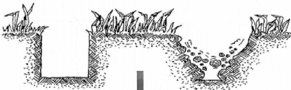
Si el terreno permite un corte limpio del mismo será suficiente realizar una zanja del ancho necesario para hacer el mismo.
