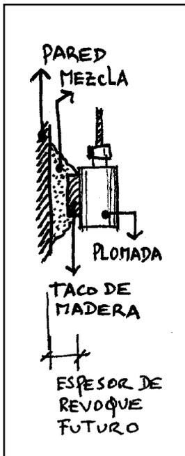
De uno de los lados de la pared debemos colocar próximo al techo un taquito de madera, amurado con mezcla gruesa cuya superficie diste de la pared una distancia igual que el espesor del revoco.
