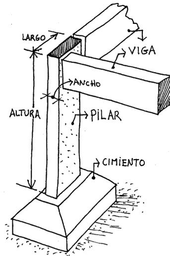
Obteniendo el metraje de hormigón de un pilar, podremos multiplicarlo por la totalidad de los pilares iguales que tengamos. Este valor final lo multiplicaremos por los valores de abajo y obtendremos la cantidad de material necesario.
