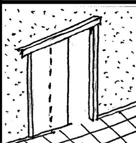
**PUERTA CORREDIZA:** La hoja de la puerta corre colgada por una guía metálica. Sirve para aquellos lugares que no hay lugar para el movimiento de una hoja de puerta normal. Si la guía no está puesta entre dos muros, tendremos el problema de que no podremos recostar nada sobre la pared en el sitio que corre la hoja.
