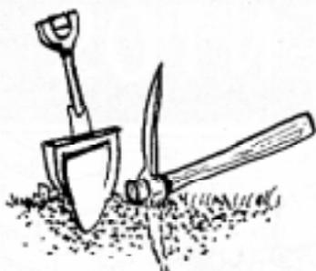
Si la pala rebota o clava poco en el suelo y es necesario usar el pico para ayudar, clasificaremos a este suelo como: semi-duro, su resistencia es apta para una cimentación normal.
