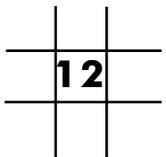
Este número en el medio del cuadrado indica el espesor de hormigón que deberá llenarse (la altura del hormigón).
