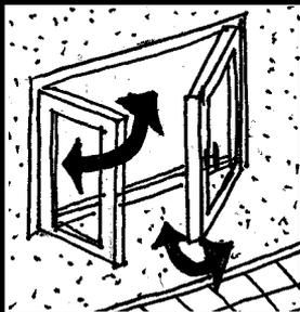
**VENTANA BATIENTE:** permite una ventilación total del hueco de la ventana. Se le puede colocar cualquier tipo de protección exterior como ser cortina de enrollar, postigón, etc. Permite la limpieza fácil de los vidrios sin tener que salir. Lo que se hace difícil es dejar una endija pequeña abierta para invierno o días de lluvia.
