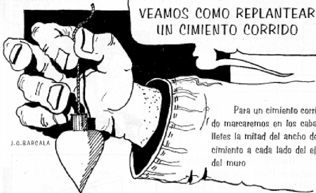
Para un cimiento corrido marcaremos en los caballetes la mitad del ancho del cimiento a cada lado del eje del muro
