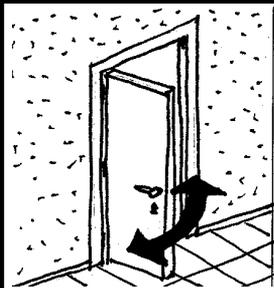
**PUERTA BATIENTE COMUN:** es la normal en toda vivienda. Las hay para exterior (puerta de entrada), y de interiores. Existe una gran gama de diseños y precios. Las exteriores tienen que ser resistentes a la intemperie. Las hay de hoja derecha (si al empujar abren a la derecha), e izquierdas (si al empujar abren a la izquierda).
