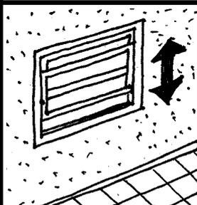
**VENTANA DE GUILLOTINA:** permite una buena ventilación y control de la misma. Acepta cualquier tipo de protección. Son de difícil limpieza, hay que limpiar una cara desde el exterior. Como en el caso de la corrediza, solo queda abierta la mitad de la ventana.
