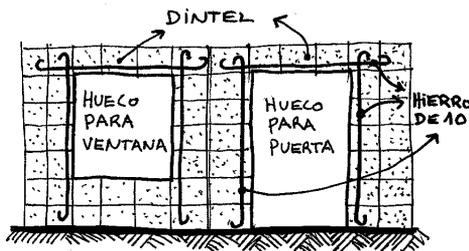
Para poder colocarlo se va rompiendo el fondo del bloque en cada hilada de forma de dejar un hueco del alto del muro, al que llenaremos con hormigón luego de puesta la varilla.
