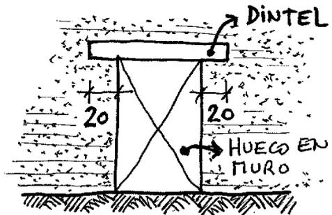
Para una puerta normal la altura usual de comenzar el dintel es a 2,10 metros, ya que 2,05 metros suele tener de alto una abertura estandar que compremos en una barraca.
