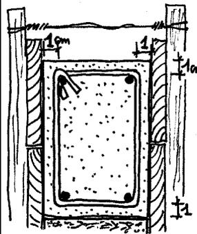
Cuando se llena el encofrado de hormigón hay que cuidar de que los hierros no apoyen contra la madera.
