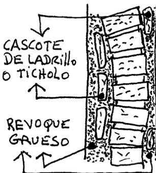
Si la pared está muy torcida deberemos ir cargándola con mezcla de a poquito, para que no se raje y desprenda. Que los muros queden fuera de plomo genera un gasto de mezcla innecesario, y una pérdida de tiempo importante muchas veces es necesario aplacar cascotes de ladrillo o ticholos para cubrir las imperfecciones.
