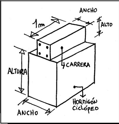
$$\text{ALTURA} \times \text{ANCHO} \times 1 \text{ m} = \text{Volumen de hormigón ciclópeo en 1 metro de cimiento.}$$
