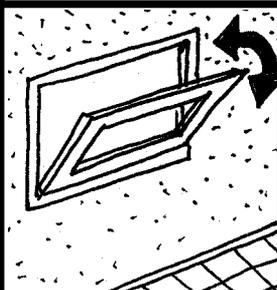
**VENTANA TABAQUERA:** muy común en baños, permite una ventilación buena, ayuda a generar circulación de aire alta. Es posible colocarla fuera del alcance de la mano, ya que se la puede manejar a distancia por medio de un comando a simplón. Como suele colocarse alta, se hace difícil la limpieza de la cara exterior del vidrio.
