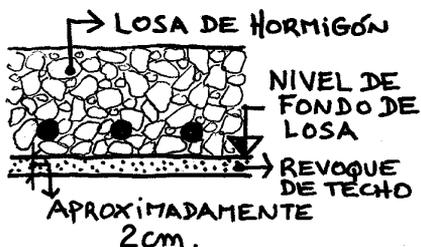
Deberemos ubicar en obra la altura del fondo de la losa, ésta será la suma de la altura libre del techo al piso más el revoque de cielorraso. Ese punto será la ubicación de la cara superior del encofrado que tendremos que construir.
