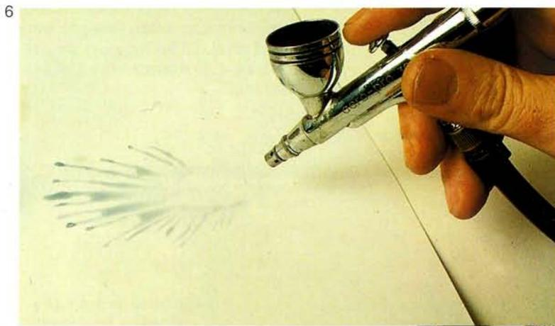
6. De nuevo, se acciona la palanca y una vez comprobado que el líquido aparece limpio podrá considerarse que el aerógrafo está impecable.
