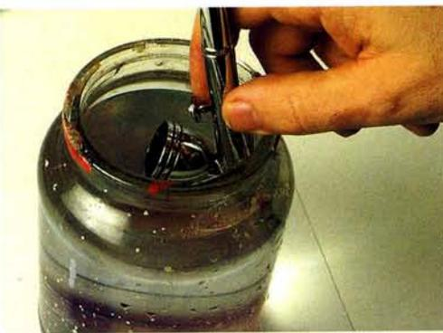
2. El aerógrafo se introduce en un recipiente con agua limpia para que el color se vaya desprendiendo del interior del depósito.
