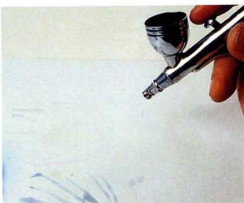
3. Otra vez, con el depósito lleno de agua, se acciona la palanca para que el juego de ida y vuelta que ejerce la aguja vaya arrastrando los residuos de color.
