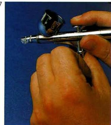
7. Aunque el depósito del aerógrafo tiene una capacidad determinada, nunca debe llenarse totalmente para evitar goteos innecesarios.
