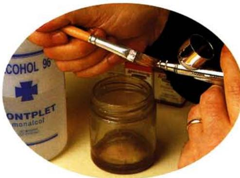
La necesidad de limpiar la cabeza del aerógrafo se hace imprescindible para obtener un trazo correcto y fluido. En esta ocasión se usa un pincel de cerda previamente mojado en alcohol.
