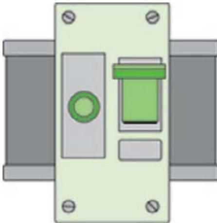
Protege toda la instalación y al usuario contra contactos directos (tocar directamente un conductor activo) e indirectos (fallo en un aparato desviando la corriente eléctrica a través de sus partes metálicas) y evita el riesgo de incendios. Se debe elegir uno adecuado a la potencia contratada y de una sensibilidad de 30 mA.
