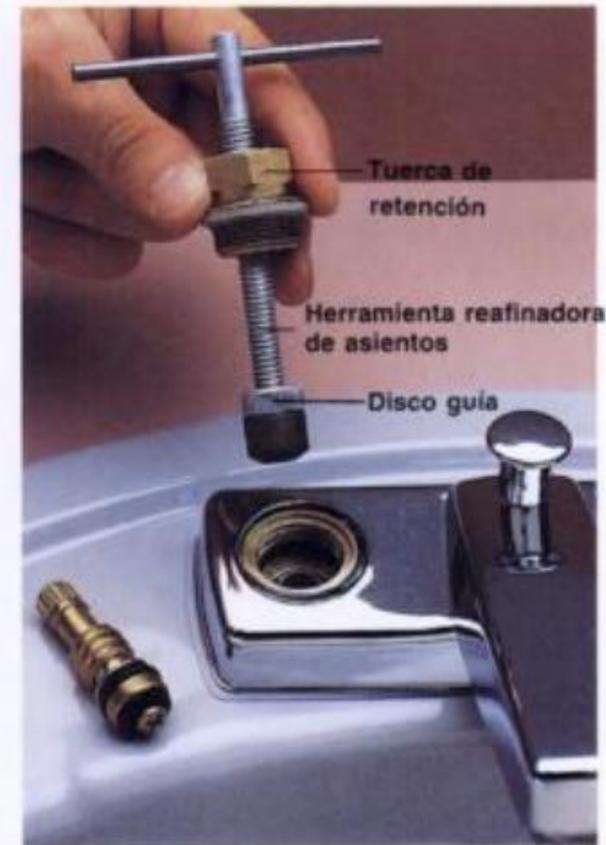
**Para rectificar** (reafinar) un asiento de válvula seleccionar un disco guía que se adapte al grifo. Fijar el disco a la herramienta rectificadora e insertar la tuerca de retención. Apretar ligeramente la tuerca de retención hacia adentro del grifo. Presionar ligeramente la herramienta hacia abajo y girar el esmerilador en sentido de manecillas de reloj. El asiento queda rectificado cuando la herramienta gira fácilmente.
