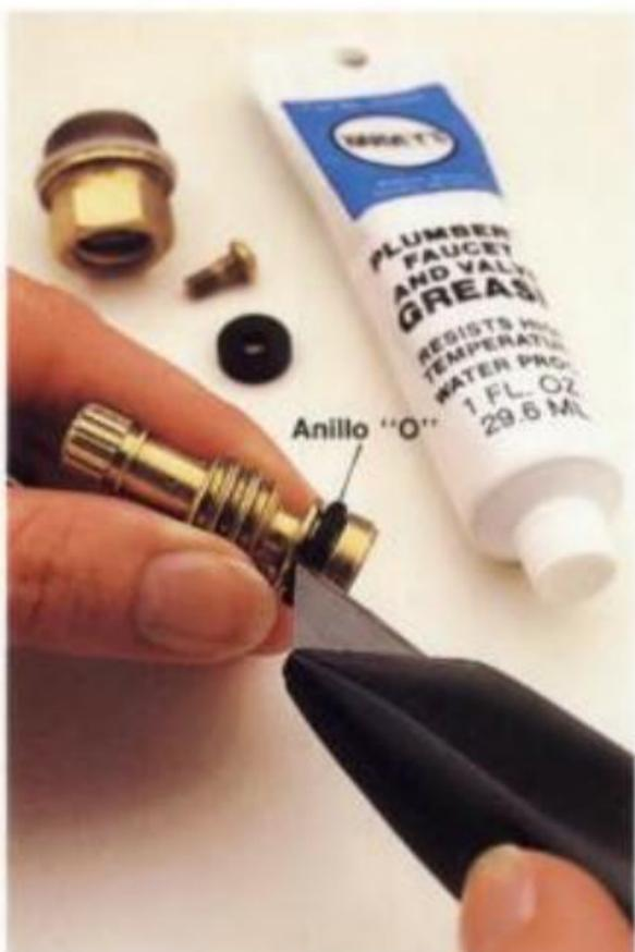
**4** Cortar con navaja el anillo "O" del vástago. Instalar un repuesto exacto del anillo "O". Untar grasa a prueba de calor en todas las piezas móviles, incluido el portamanija. Examinar el asiento de válvula (página siguiente). Si está picado, cambiar o reafinar el asiento de válvula antes de ensamblar de nuevo el grifo.
