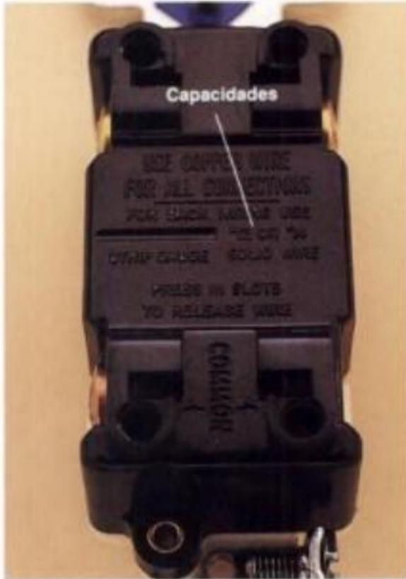
**Lea las marcas** de las cajas de salida y de los interruptores usados antes de comprar los repuestos. Se deben seleccionar repuestos de las mismas capacidades de voltaje y amperaje. Si el alambrado es de aluminio o si el enchufe o interruptor viejos están marcados CO/ALR, compre un repuesto similar.
