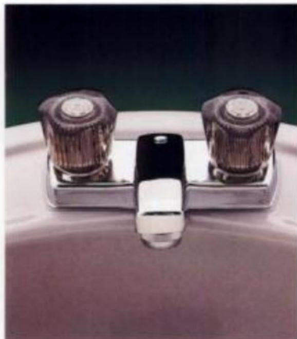
**Los grifos de compresión** (de vástago y asiento) de muchos lavamanos de dos llaves y los accesorios de baño tienen roldanas de neopreno que comprimen contra un asiento de válvula. Las tapas índice de la parte superior de las llaves del grifo ocultan los tornillos de las llaves.
