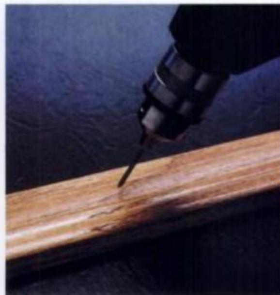
**Pretaladrar la madera** para evitar que se rajen. Usar un clavo sin cabeza como broca para perforar rápida y exactamente el orificio del calibre requerido.
