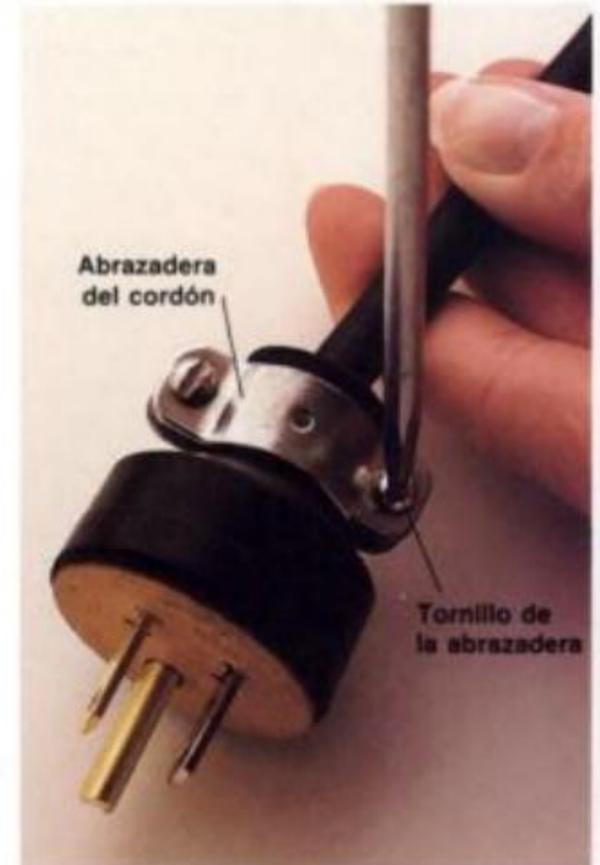
**3** Apriete los tornillos firmemente, asegurándose de que los alambres de cobre no se tocan. Cambiar el disco aislante. Si la clavija tiene grapa para el cordón, apretar firmemente sus tornillos.
