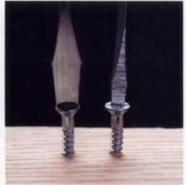
Seleccionar el desarmador apropiado a la ranura de la cabeza del tornillo. La hoja angosta del desarmador de la derecha puede zafarse y dañar la cabeza del tornillo.
