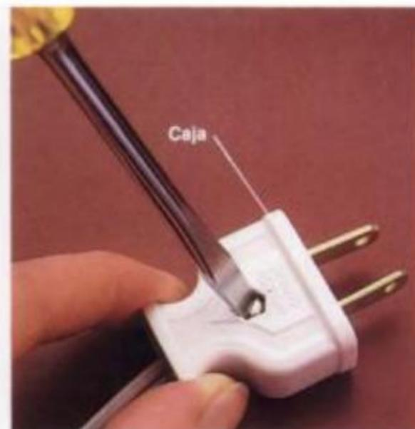
**3** Ensamble de nuevo la caja de la clavija. Cambie la placa aislante protectora, si la lleva la clavija.
