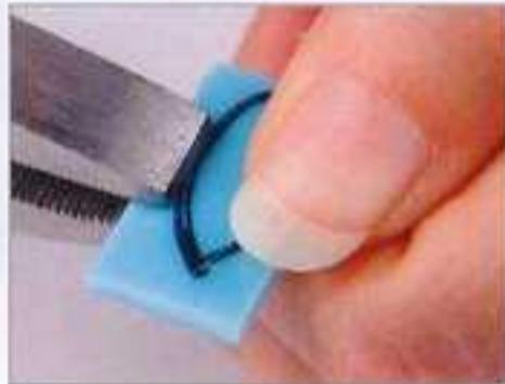
6. Sujetar el vidrio con el alicate devastador o de corte curvo.
