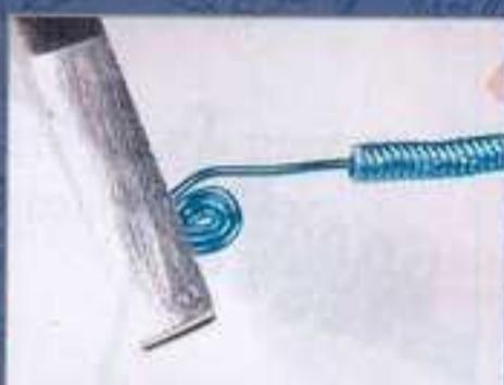
15. En el extremo del alambre que quedó en la colita, formar un bastón, girar el alambre alrededor de este para formar un giro de cuatro vueltas.
