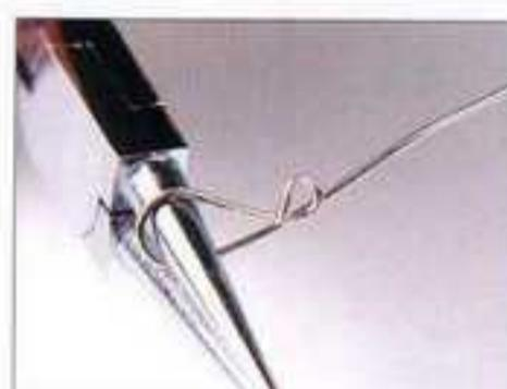
7. **Adorno:** con el alicate de punta redonda formar una oreja grande con el extremo del alambre. En la parte más ancha girar el alambre en sentido contrario.
