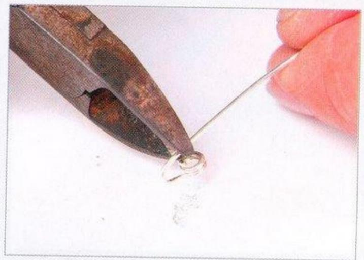
**12.** Levantar el palito quebrado hacia la izquierda, hacer una pequeña uñita, ponerla dentro de las 2 argollas.
