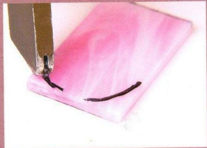
4. En ambos rectángulos dibujar la silueta del derriere del gato, rayarla con el cortador de vidrios.
