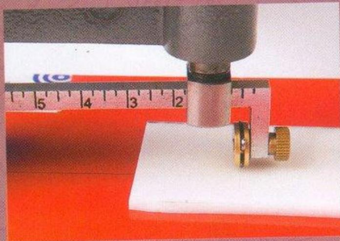
1. Rayar un círculo de 2 cm de diámetro con el cortador de círculos.
